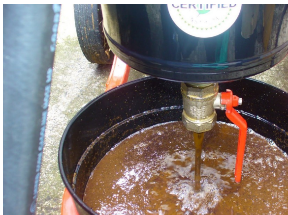
Figuras 22/23 - Contaminação por água emulsionada e material sólido abrasivo
