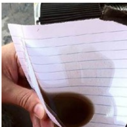
Figuras 1/2 - Óleo Diesel Rodoviário contaminado com material particulado sólido
