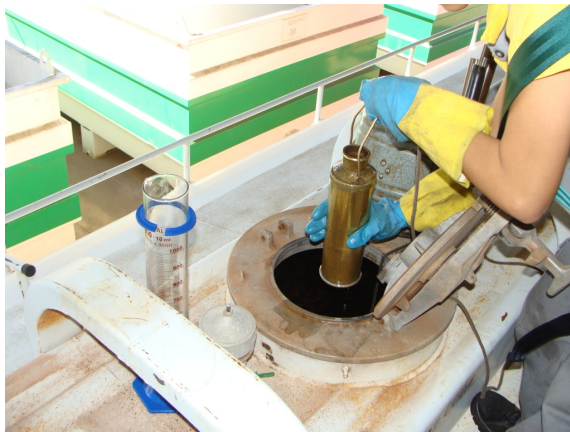
Figuras 26/27 - Procedimentos de recebimento de caminhões-tanque e drenagem de tanques de armazenamento de combustível
