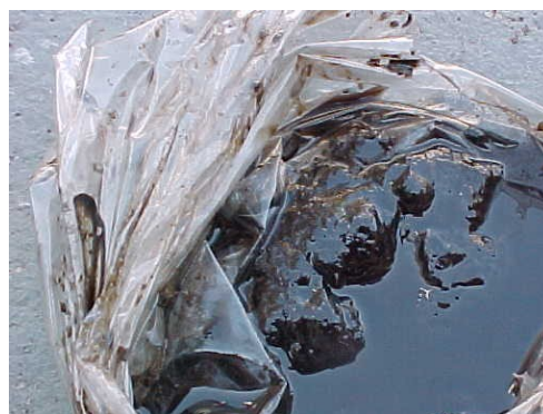
Figuras 14/15 – Lastro não drenado de fundo de tanque de combustível
