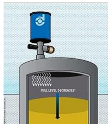
Figuras 30/31 - Filtros em tubos de respiro são de fundamental importância
