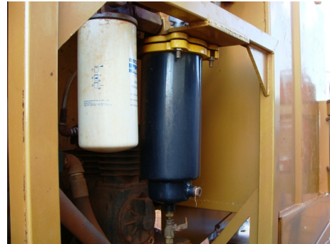
Figuras 33/33 - Filtros coalescentes/separadores/micrônicos em bomba de dispensa e em comboio de abastecimento
