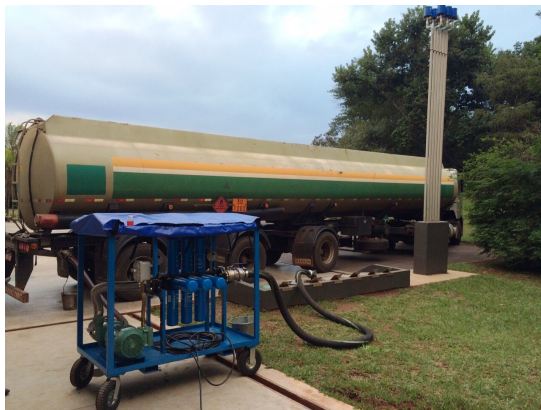
Figuras 28/29 - Filtração do Óleo Diesel Rodoviário na descarga
