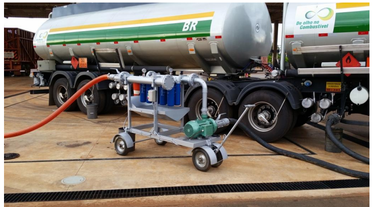
Figuras 28/29 - Filtração do Óleo Diesel Rodoviário na descarga
