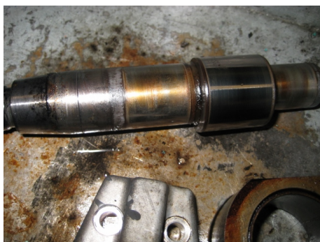
Figuras 34/35 – Sistema de injeção danificado e maquinário indisponível
