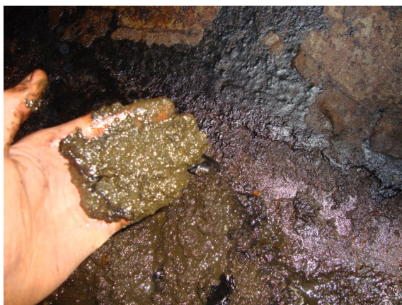
Figuras 20/21 - Borra formada em tanques de Óleo Diesel Rodoviário
