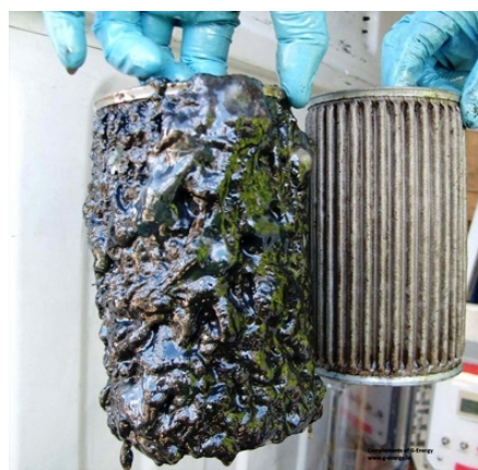
Figuras 20/21 - Borra formada em tanques de Óleo Diesel Rodoviário
