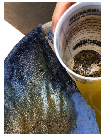
Figuras 22/23 - Contaminação por água emulsionada e material sólido abrasivo
