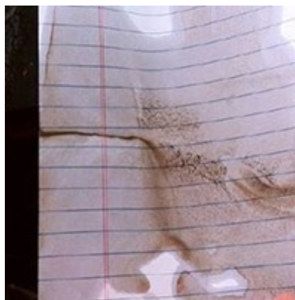
Figuras 1/2 - Óleo Diesel Rodoviário contaminado com material particulado sólido
